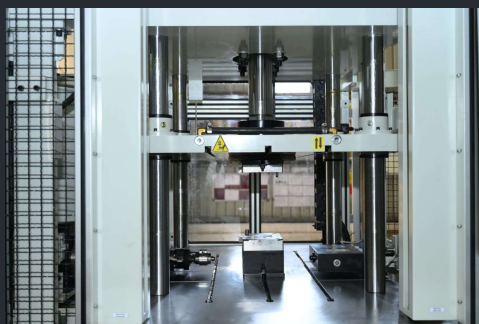
Запрессовка стержней
