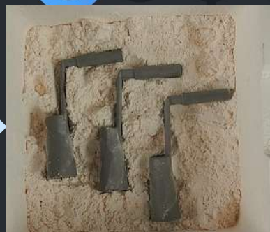
Формовка стержней в короба
