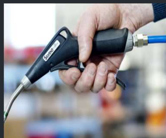
Обдувка стержней сжатым воздухом
