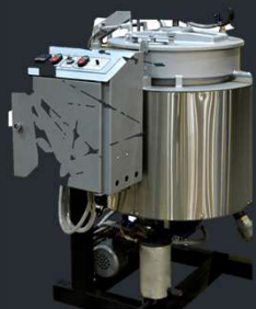
Приготовление стержневой массы в вакуумных смесителях
