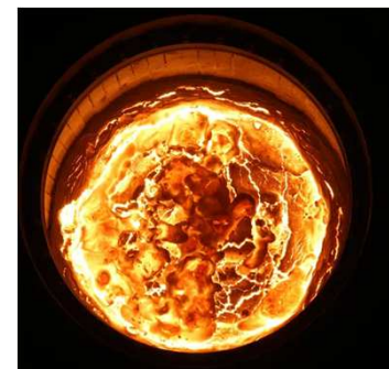
Установка ИГПХТ-60 кВт для получения оксидных плавящихся высокотемпературных соединений до 3500 C
