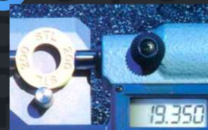
Температурный контроль термоиндикаторными кольцами
